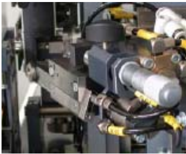
Modulo di spelatura con cassetta di spelatura
