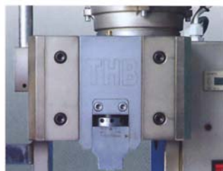
Sistema di regolazione dell'altezza di aggraffatura (precisione 0.03 mm)
